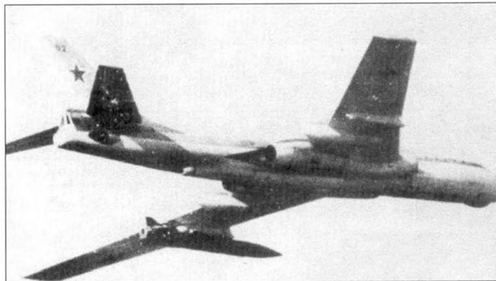
Badger G вооруженный ракетой КСР-5, подвешенной на левом пилоне. Сверхзвуковая противокорабельная ракета дальнего действия КСР-5 была специально разработана для поражения американских авианосцев и могла оснащаться ядерной боевой частью.
