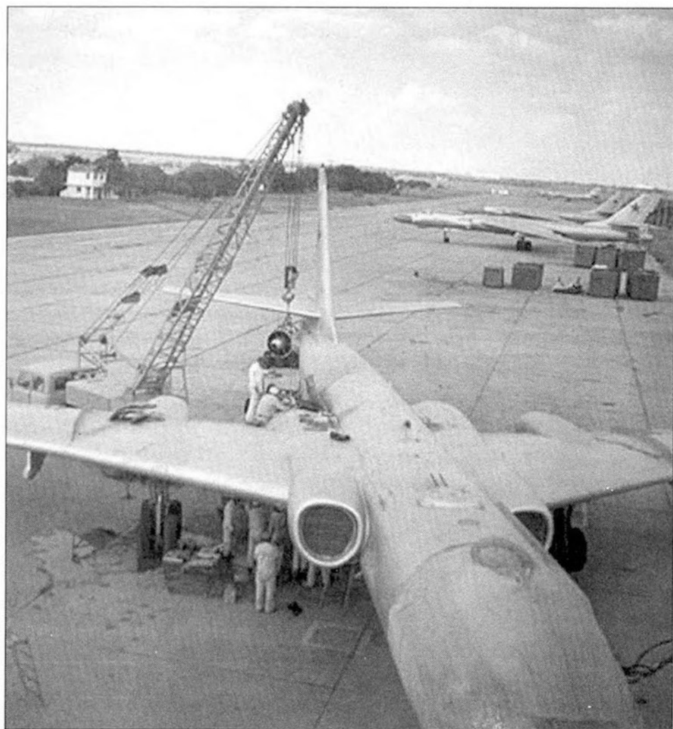
Установка двигателя на Ту-16
