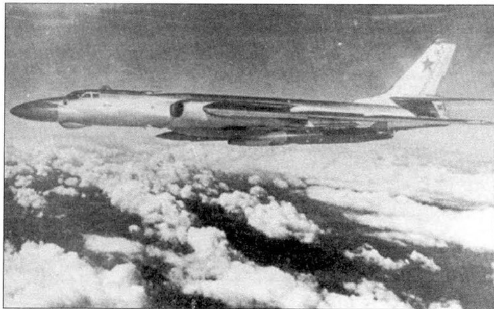
Badger C модифицированный для подвески двух КСР-5 на подкрыльевых пилонах и К-10 под фюзеляжем.
