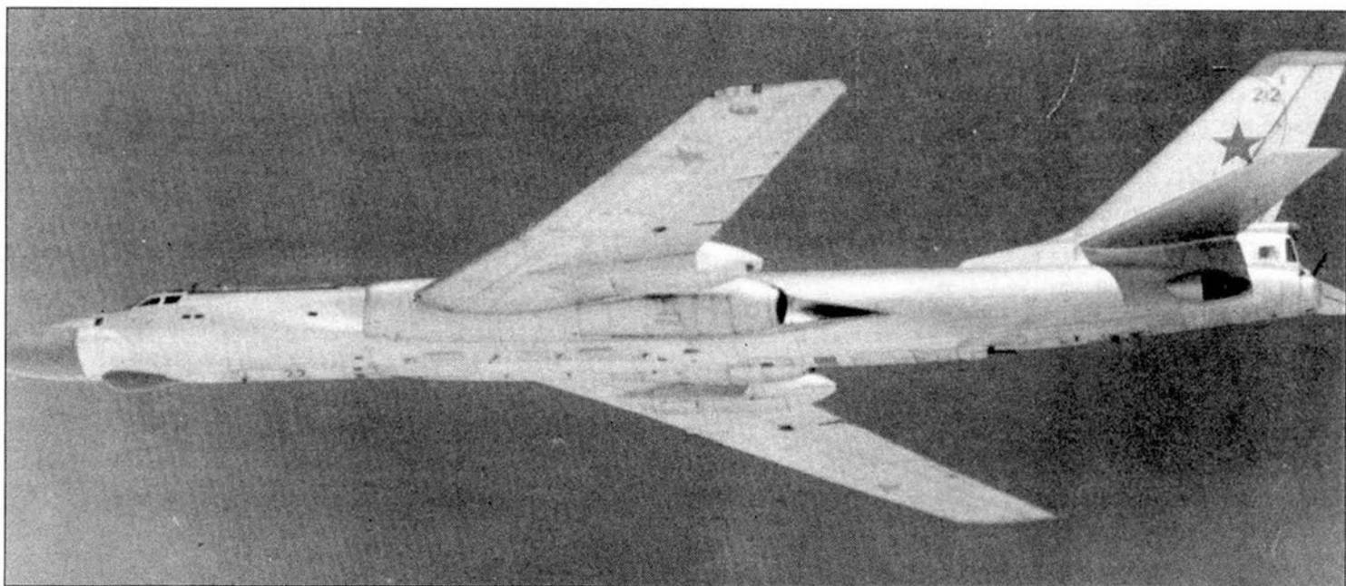
Ту-16К-10 (Badger C) во время полета над Тихим океаном вблизи группы американских военных кораблей, 1984 г. Badger C имел дополнительные небольшие оконца на борту фюзеляжа сразу за кабиной. Tактический номер указывает на то, что это самолет из второй эскадрильи.
