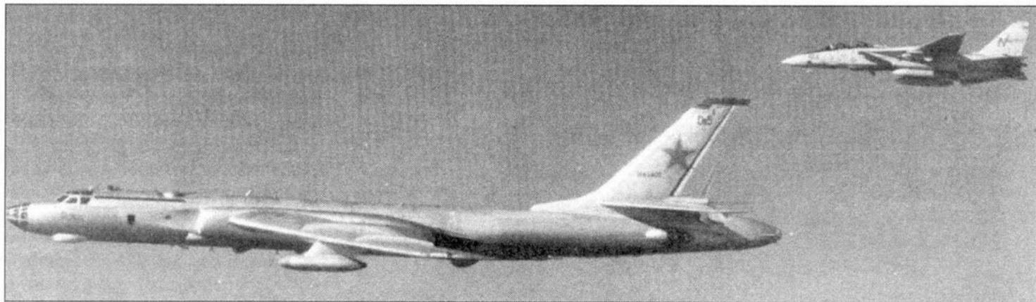
Ту-16Р Badger F в сопровождении истребителя F-14A «Томкет» ВМС США, Ту-16 имеет модифицированную хвостовую часть с обтекателем, установленным на месте кормовой стрелковой установки. Подобные хвостовые обтекатели устанавливались и на Ту-142 Bear F.
