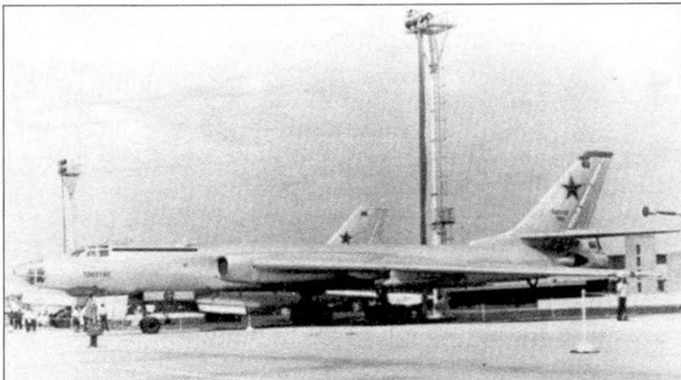
Ту-16 КС-1 (Badger В) с подкрыльевыми пилонами для подвески КС-1. Самолет полностью цвета натурального металла, тактический номер «62» (красный) нанесен на хвосте и створках ниши переднего шасси.
