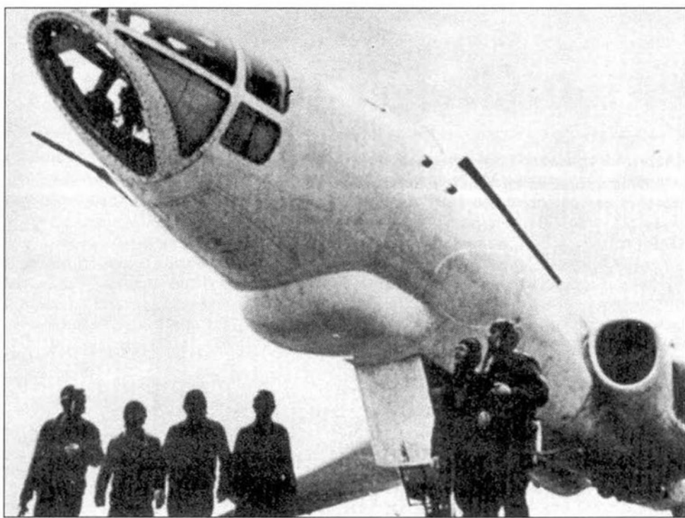
Постановщики помех Ту-16ПП Badger J, перестроенный из Ту-16А. В боевой обстановке Ту-16ПП должны были сопровождать группы ракетноносцев Ту-16, защищая их от вражеских радаров.
