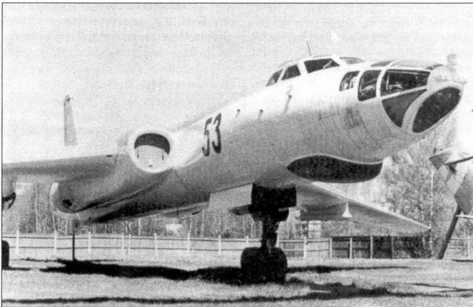
Badger G с антенной станцией «Рица» установленной на переплете кабины штурмана-бомбардировщика.
