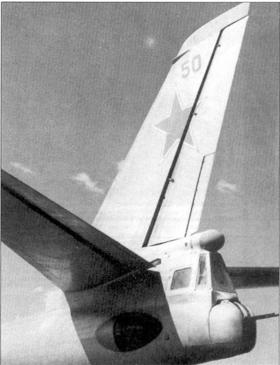
В задней части фюзеляжа располагалась кабина стрелка кормовой стрелковой установки и оператора подфюзеляжных стрелковых установок, а так же радиолокационный прицел ПРС-1. Позади кабины под горизонтальным стабилизатором виден большой блистер.
